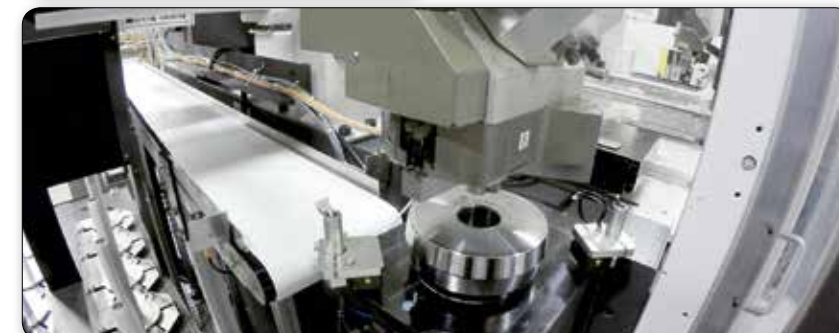
A Hunter gyártási folyamata 90 másodperc alatt állít elő egy kúpot.
