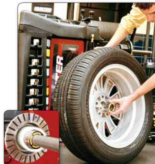
Hunter duplafalú kúpok optimális felfogást biztosítanak a kiegyensúlyozás alatt.
