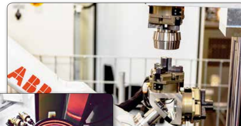
Fent: A robotkar végigviszi a kúpot a nyolclépéses gyártási folyamaton.
