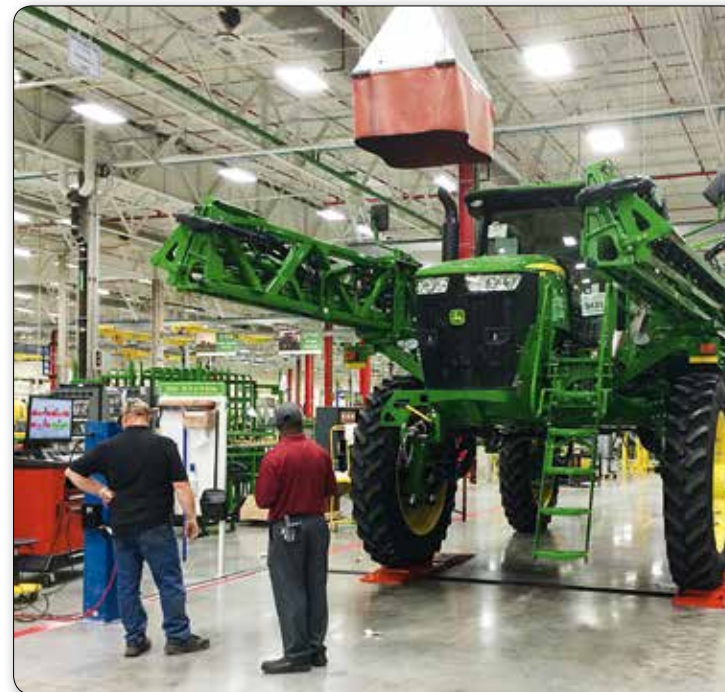
John Deere audit minden egyes öntöző traktor esetén - az Iowai gyárban - Quick Check rendszerrel történik, mielőtt az a forgalmazókhoz kerül.
